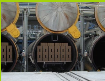
Abb. 8: Autoklaven zur Herstellung von Alpha-Halbhydrat
