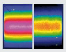
Unabhängige Messungen bestätigen die schnellere Aufheizung von Fließestrich (linke Bildhälfte) im Vergleich zu konventionellem Estrich (rechte Bildhälfte). Wärmebild nach ca. 1,5 Std. – von grün nach violett zunehmende Temperatur über dem Heizrohr.
